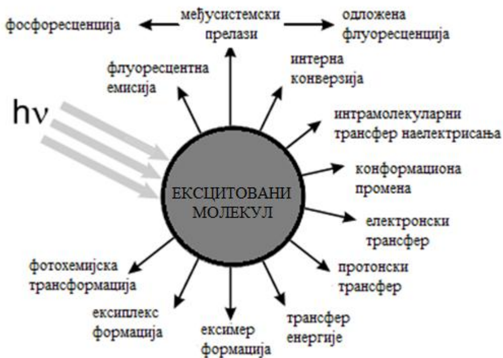
Слика 2.3. Могући деекситациони механизми ексцитованог молекула.
