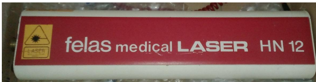
Слика 3.1.6. Ласер коришћен за озрачивање зрна узорака.
